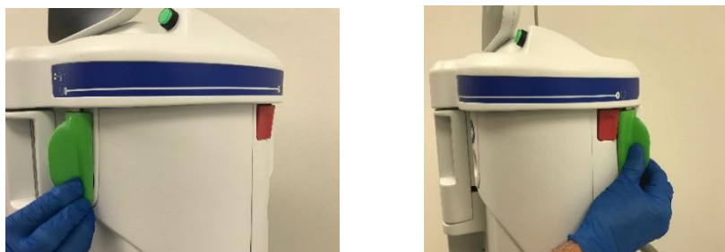
Figura 6. Accensione della console del sistema DownStream®
