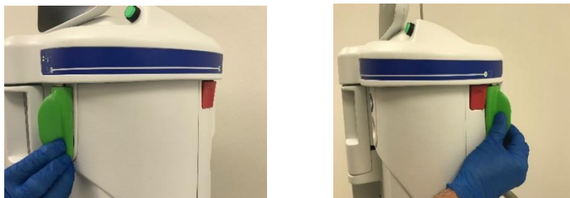
Afbeelding 6. De DownStream®-systeemconsole inschakelen
