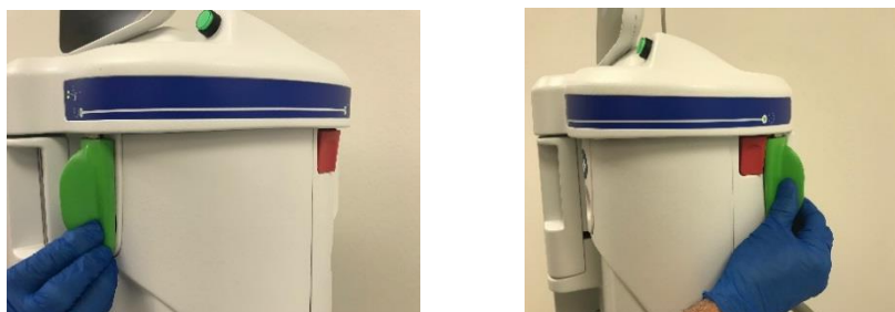
Figure 6. Mise sous tension de la console du système DownStream®
