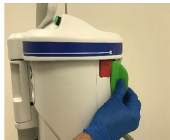
Abbildung 6. Einschalten der Stromversorgung der DownStream® System-Konsole
