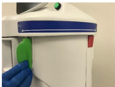
Abbildung 6. Einschalten der Stromversorgung der DownStream® System-Konsole
