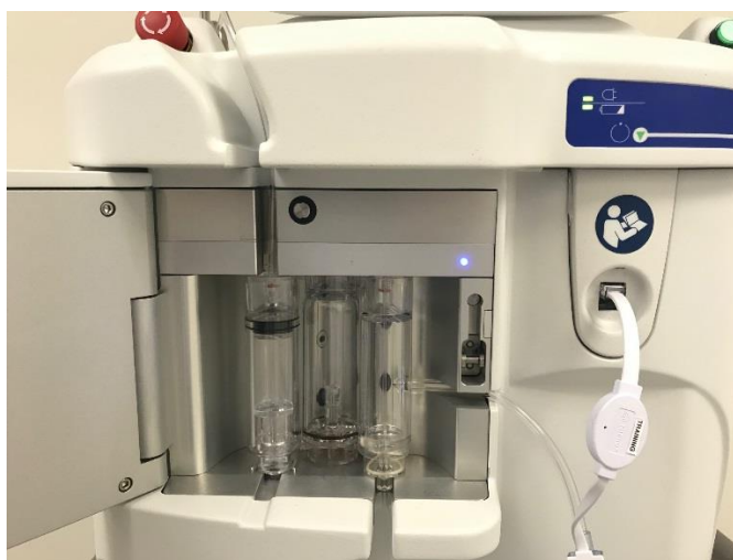
Afbeelding 10. Compartiment voor DownStream-cassette
